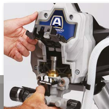
2. EXTRAIGA LA SECCIÓN DE LA BOMBA
