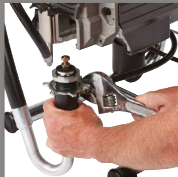
3. DESCONECTE LAS MANGUERAS
